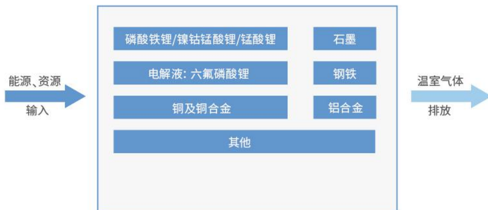
图B.24锂离子动力电池包碳排放核算的系统边界
