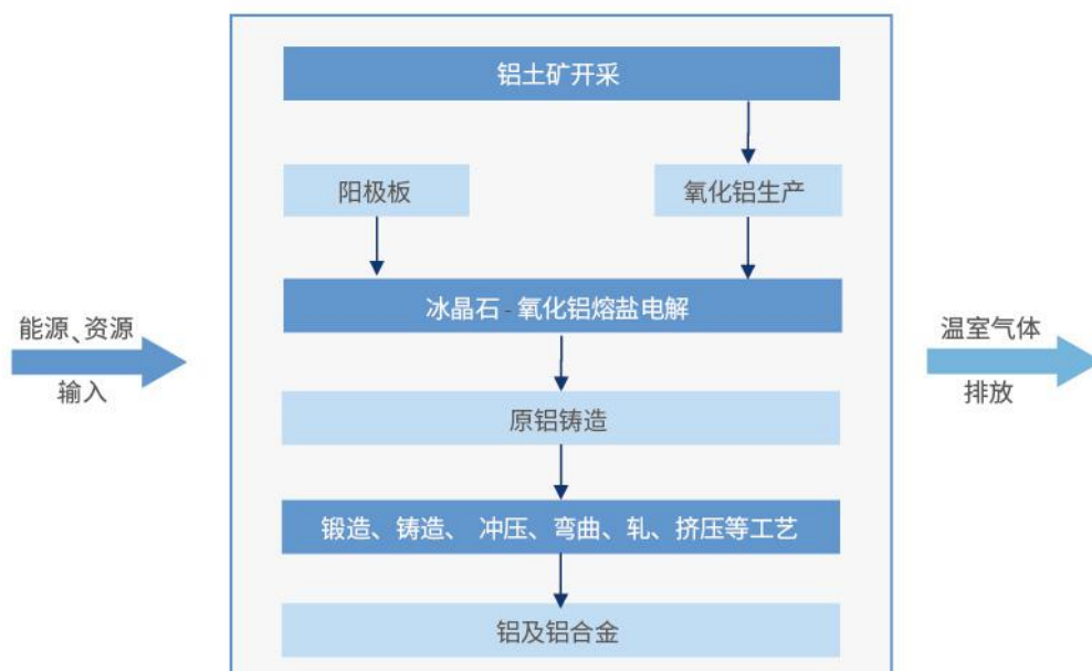
图B.3 铝及铝合金材料碳排放核算的系统边界
